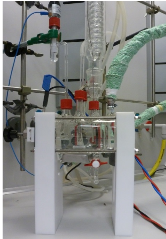
Abbildung 21: Elektrochemische Drei-Elektroden-Zelle für temperatur- und potentialabhängige Korrosionsmessungen.
