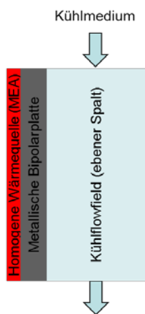
Abbildung 6: Randbedingungen für vereinfachte wärmetechnische Simulation
