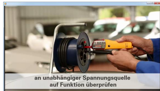
Abbildung 26 – Hinweise für das Prüfen von Messgeräten und Werkzeugen
