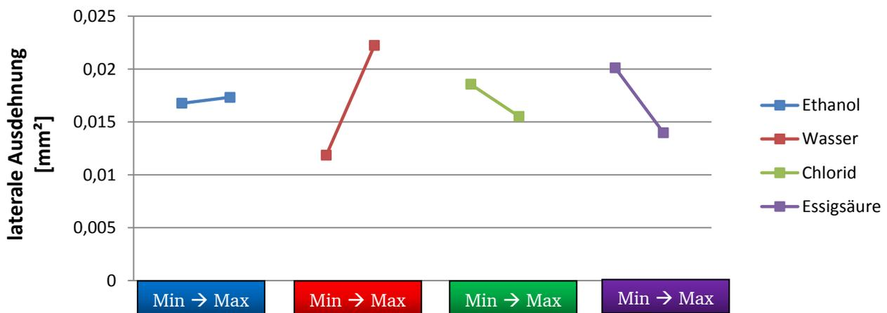
**Bild 29: Haupteffekte der Kraftstoffkomponenten auf das Qualitätsmerkmal laterale Ausdehnung**
