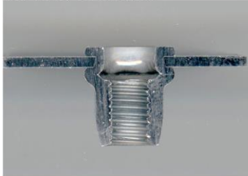
Abbildung 6.1-2: RIVKLE® Blindnietmutter M6 (HRT), Schraubengüte 12.9
