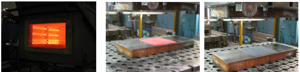
Abbildung 2.5-3: Erstellung von warmumgeformten Flachproben
