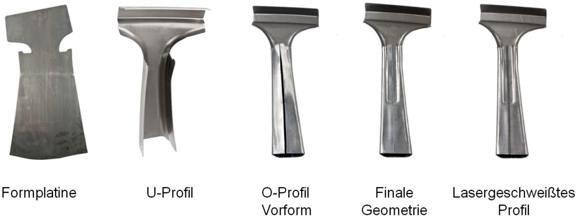
Abbildung 2.8-5: Fertigungsschritte der T 3 B-Säule
