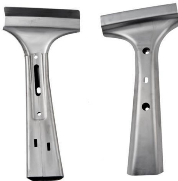
Abbildung 2.8-6: T 3 -B-Säulen Demonstrator mit Montagelöchern
