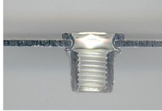
Abbildung 6.1-1: RIVKLE® Blindnietmutter M6 (Standard), Schraubengüte 8.8
