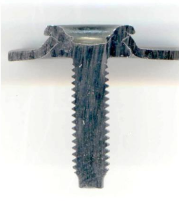
Abbildung 6.1-7: SBF Bolzen M6
