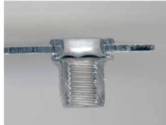
Abbildung 6.1-2: RIVKLE® Blindnietmutter M6 (HRT), Schraubengüte 12.9
