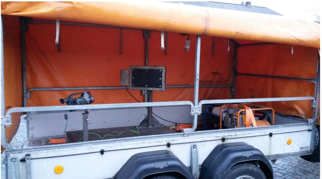
Abbildung 13 Messaufbau mit Heizplatte, IR-Kamera und Generator
