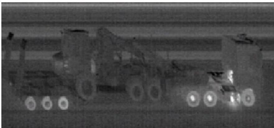
Abbildung 4: IR-Linienbild eines LKW
