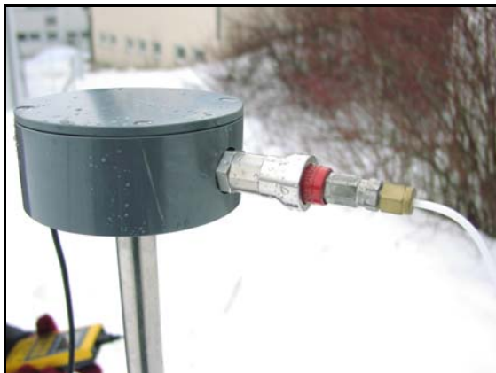
Abbildung 10: Kopf der Sonde, Ableitung für Bodengas.
