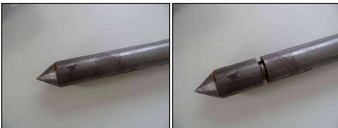
Abbildung 12: Spitze der Rammsonde, links: geschlossen. Rechts: Gaseinlass offen.
