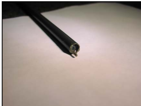
Abbildung 11: Sondenspitze, Temperaturfühler und Gaseinlass.
