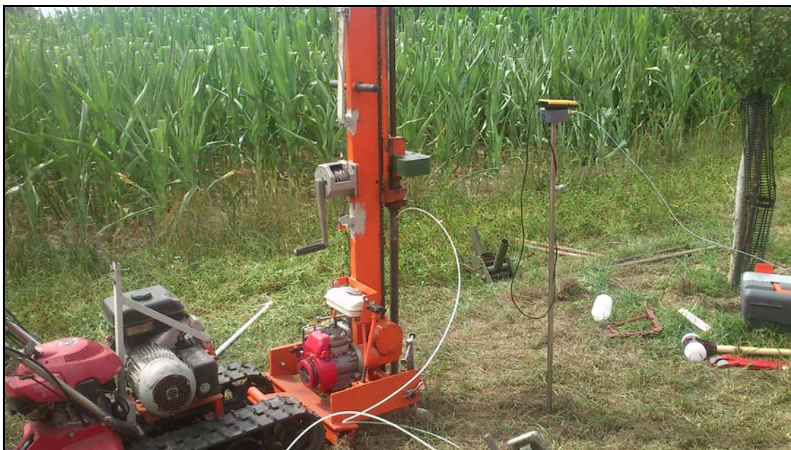
Abbildung 18: Bodengasentnahme mit der Sondierraupe und der manuellen Sonde in Ampertshausen am 08.08.2013.
