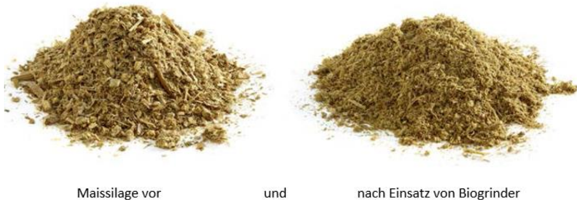
Abbildung 26: Anwendungsbeispiel des Biogrinder anhand von Maissilage [27]
