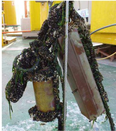
**Abbildung 6:** Hauptniveau mit Logger, Microcat , Optoden und FLNTUS (im Foulingschutz)
