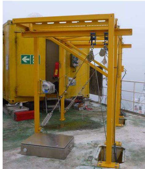
**Abbildung 12:** Davitsystem mit 2 Messsträngen (links: Entwurf IOW, rechts: Realisierung Fa. Wrede)
