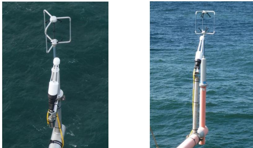
Abb. 12: Links: Gasanalysator und Ultraschallanemometer auf FINO1 in 81,5 m LAT Höhe im November 2013. Rechts: Gasanalysator und Ultraschallanemometer auf FINO1 in 41,5 m LAT Höhe im August 2013.
