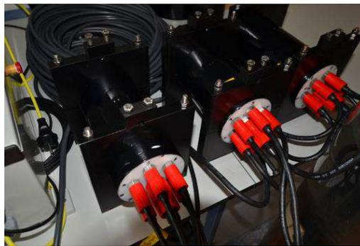
**Abbildung 5:** Unterwasserdatenlogger der Firma International Baltic Engineering GbR
