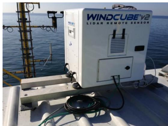
Abb. 31: *Leosphere Windcube*<sup>®</sup> v2 auf dem *alpha ventus* Umspannwerk im März 2014.
