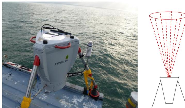
Abb. 27: Links: *Pentalum SpiDAR*<sup>TM</sup> auf FINO1 im März 2013. Rechts: Schematische Darstellung der vom *SpiDAR*<sup>TM</sup> ausgesendeten LASER-Strahlen.
