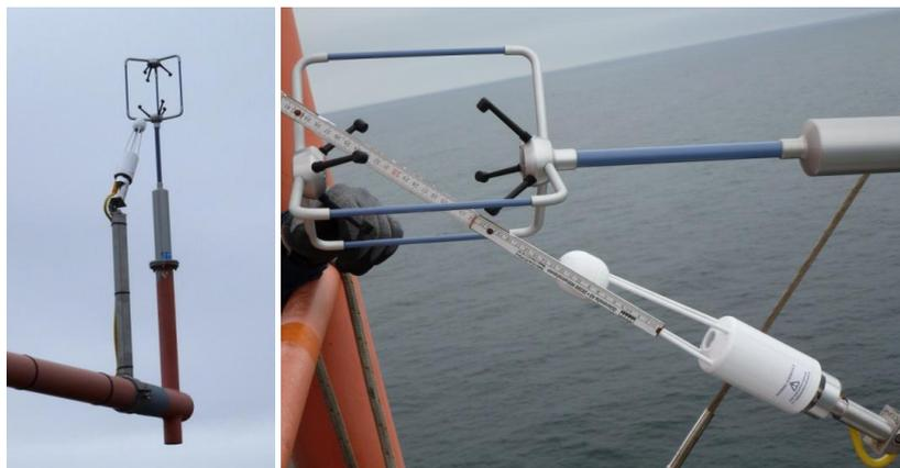
Abb. 10: Eddy-Kovarianz-Messung auf 41.5 m LAT Höhe an FINO1 (links). Position und Abstand der beiden sensitiven Volumens zueinander bei eingeklapptem Ausleger (rechts).
