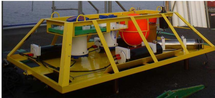
**Abbildung 8:** ADCP / NEMO Absetz-Gestell (Eigenentwicklung IOW) für ADCP und Seegangsmesssysteme incl. hydroakustischem Evologics Modem sowie Releaser
