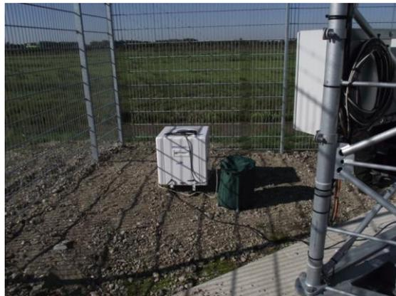
Abb. 29: *Leosphere Windcube*<sup>®</sup>v2 mit Tank für Reinigungsmittel neben meteorologischen Messmast (*AREVA*, rechts im Bild) bei Bremerhaven im Oktober 2013.
