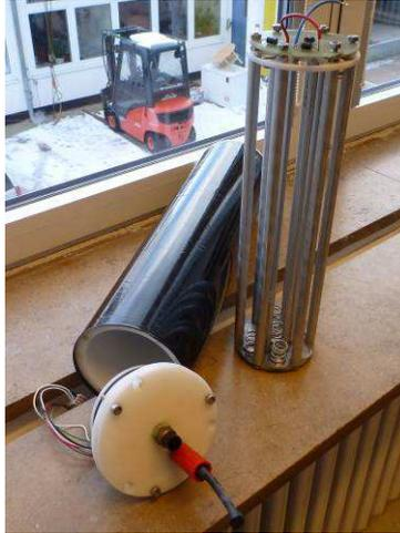
**Abbildung 9:** Version eines kostensparenden Batteriegehäuses (IOW)
