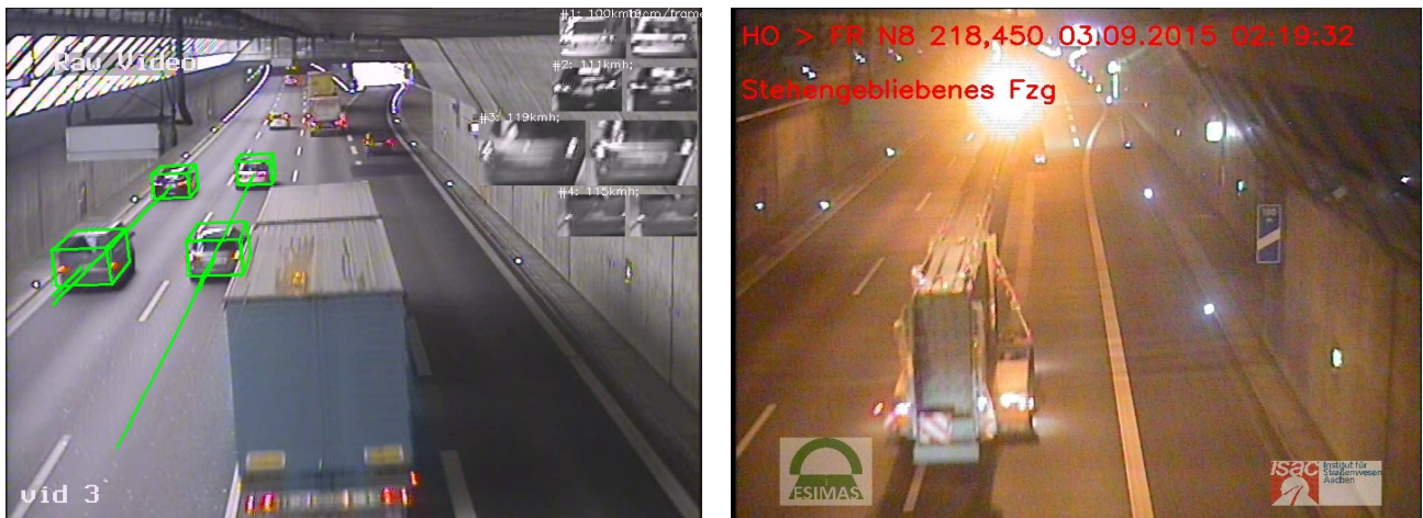
Abbildung 7: Videobasierte Fahrzeugdetektion und -verfolgung (links) und Ereignisdetektion (hier: stehengebliebenes Fahrzeug) im Demonstrator (rechts)
