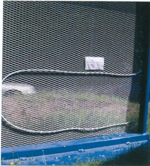
*Abbildung 13: Drei unterschiedliche Zauntypen auf dem Campus in Saarbrücken mit befestigtem Sensorkabel.*
