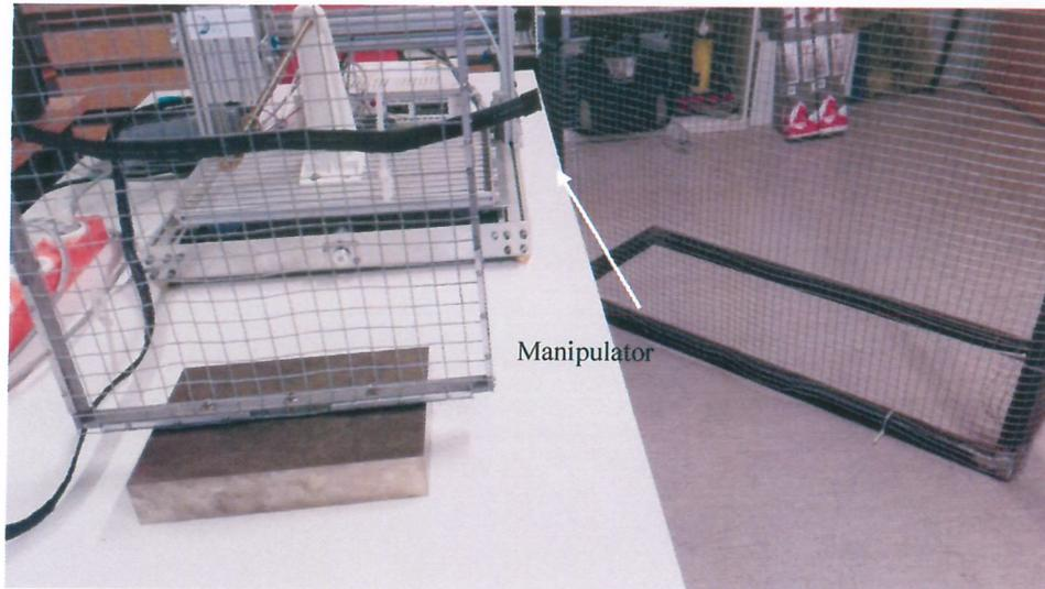
*Abbildung 12: Auf der linken Seite erkennt man an einem Zaunmodell befestigt das schwarze mit Magnetfeldsensoren bestückte Kabel. Dahinter steht der mit Schrittmotoren angetriebene Manipulator. Rechts: Weiterer Modellzaun*
