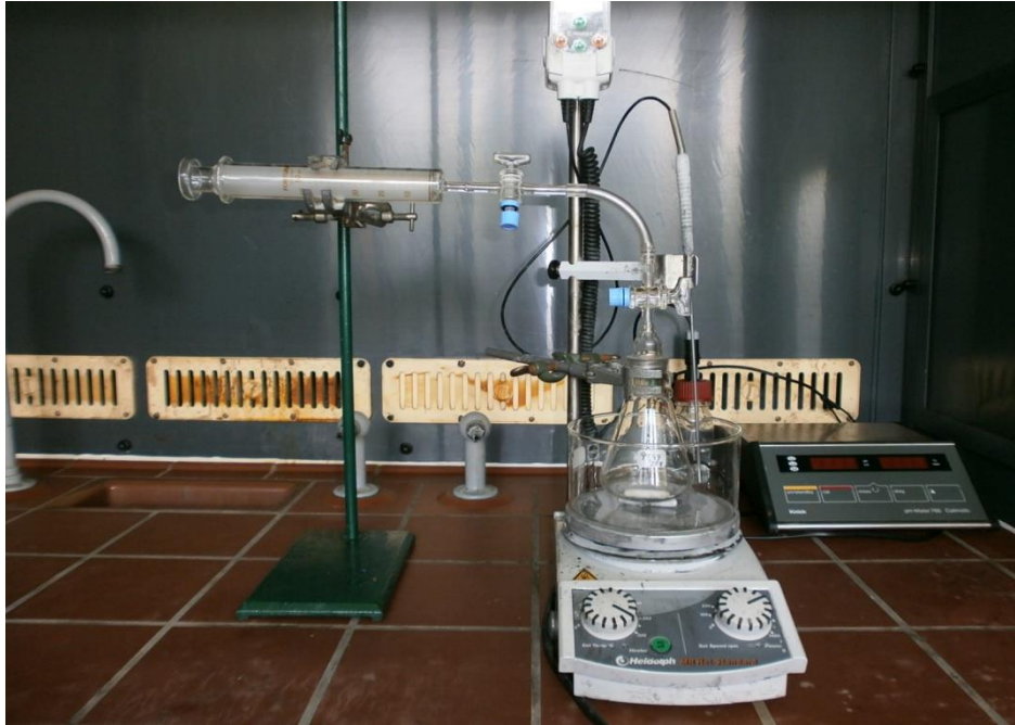
Abbildung 13: Versuchsaufbau der Kinetikmessung
