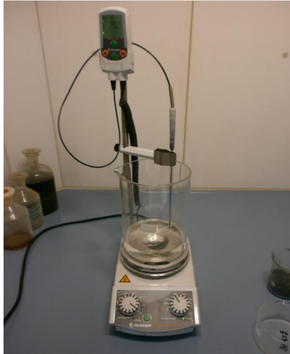
Abbildung 9: Versuchsaufbau der Laugung
