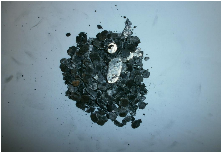
Abbildung 2: Metallhaltige Fraktion nach der Mahlung in der Walzenmühle
