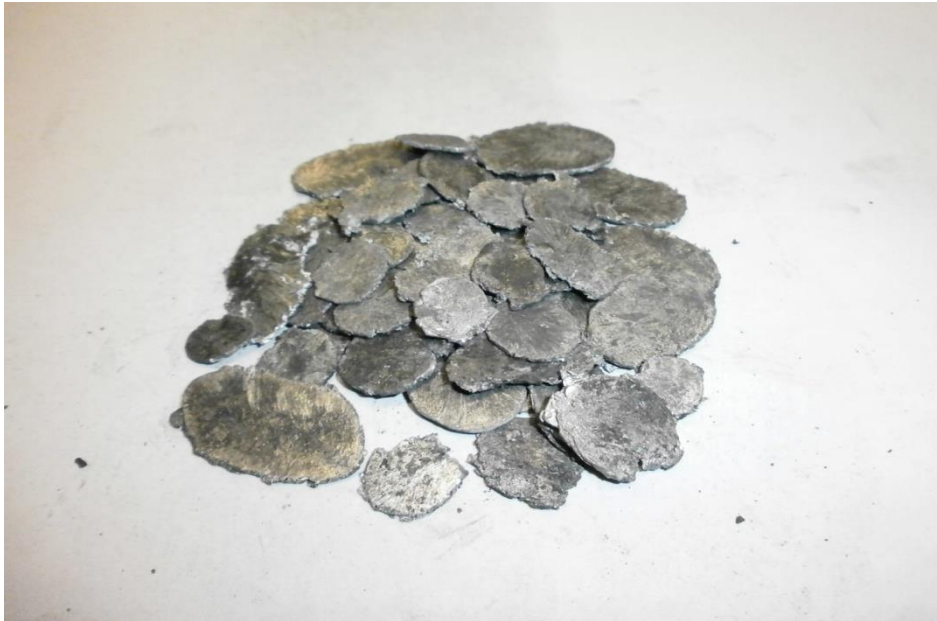
Abbildung 4: Metallhaltige Fraktion nach der Mahlung in der Gutbett-Walzenmühle
