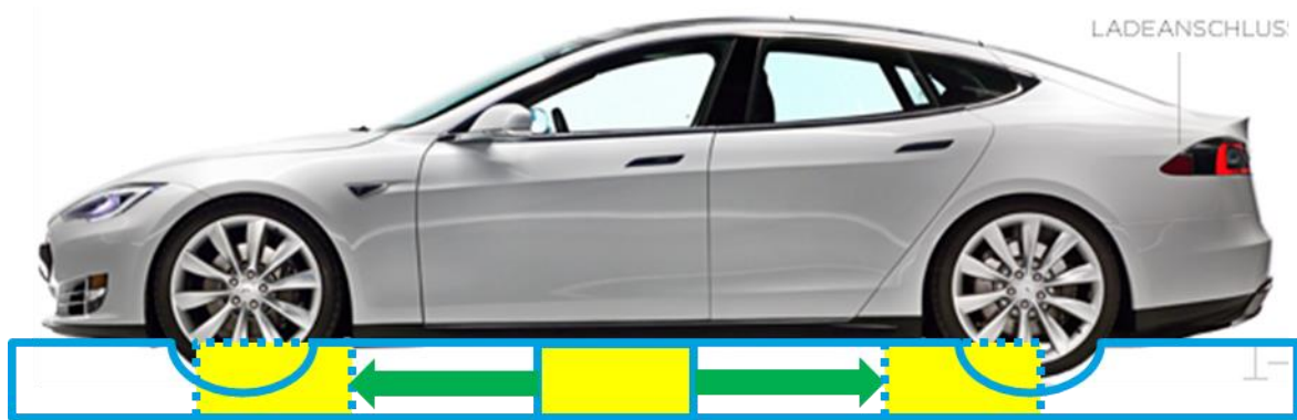
Abbildung 45 Profilansicht mit semi-mobiler Ladeinfrastruktur (Fahrzeugbild aus Produktdatenblatt unter www.tesla.com )
