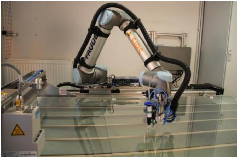
Abbildung 63: Automatisierungslösung zur Herstellung von „RDemo“-Modulen während der Produktion
