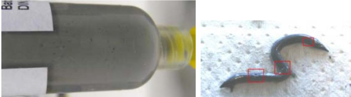
Abbildung 22: Links: Sichtbare Luftblasen an der Außenwand der Lotpastenkartusche. Rechts: Sichtbare Luftblasen innerhalb der Lotpaste nach Dispensen einer größeren Menge.
