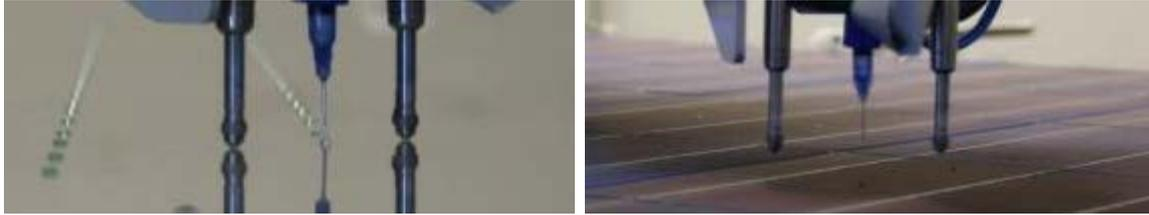
**Abbildung 44: Dispensen der Befestigungspins auf dem rückseitigen Glas (links) und Dispensen der Distanzpins auf den Solarzellen (rechts) durch die Automatisierungslösung**
