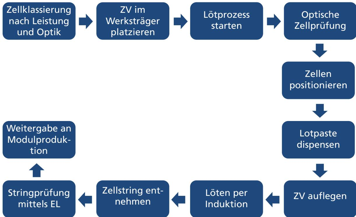
Abbildung 18: Prozessablauf zur Herstellung von Strings mit dem MWT-Rückkontakt-Stringer
