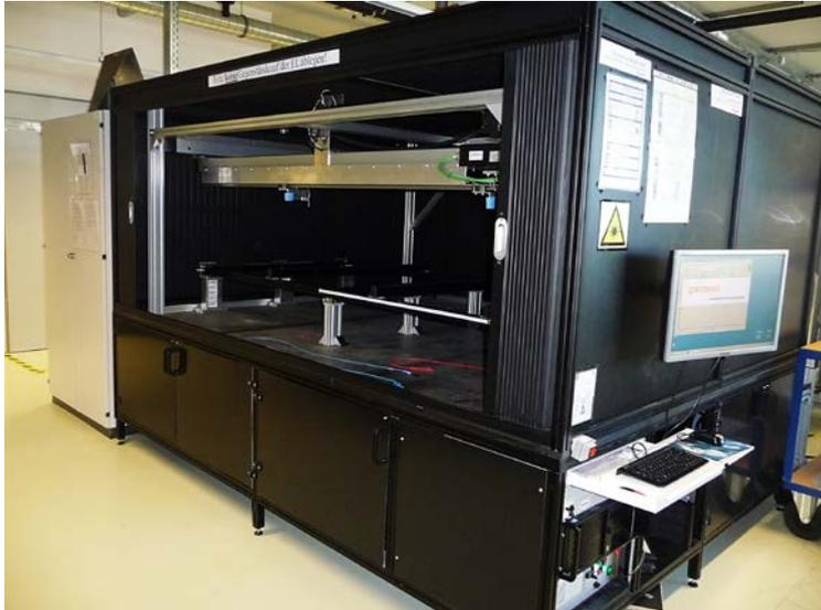
**Abbildung 27: Foto des Elektrolumineszenz-Messplatzes im Modul Technikum des Fraunhofer ISE**
