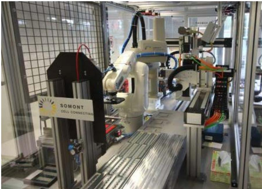
**Abbildung 17: MWT-Rückseitenstringer im Modultechnologieceter**
