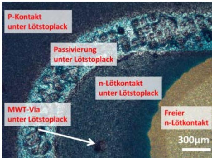
Abbildung 9: Mikroskopaufnahme des mit Lötstopplackes bedruckten n-Lötstrops (Detailansicht)
