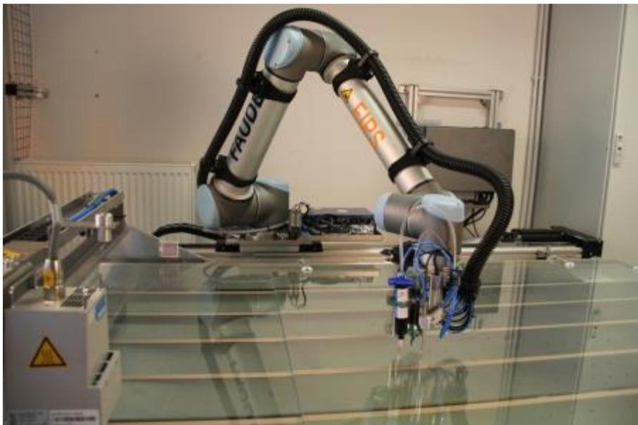
**Abbildung 43: Automatisierungslösung zur Herstellung von „RDemo“-Modulen während der Produktion**
