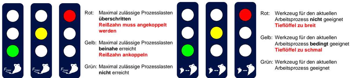
Bild 40: Erläuterung der Ampeldarstellung für die Prozessüberwachung des Tieflöffels
