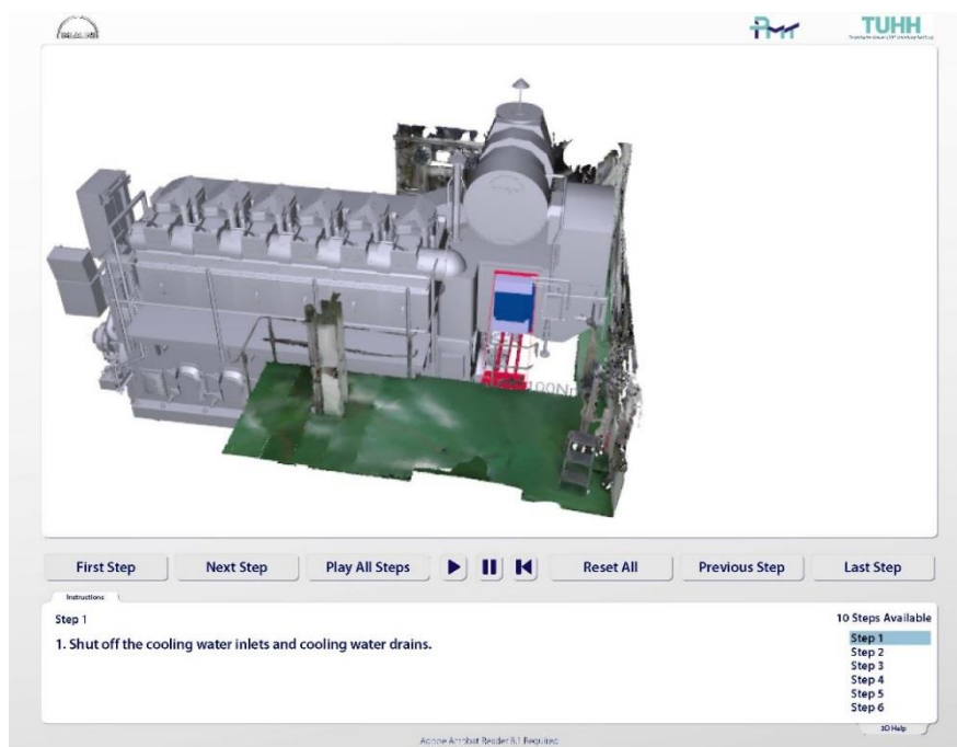
Abbildung 61: Integration bestehender 3D-PDF-Anleitungen (MAN) in Ist-Geometrie
