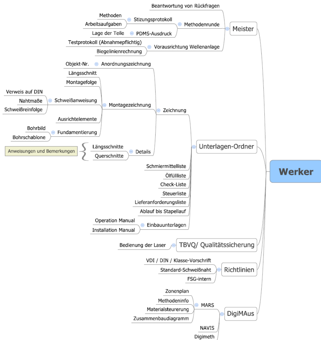
Abbildung 39: Informationsfluss an den Werker im Maschinenbau
