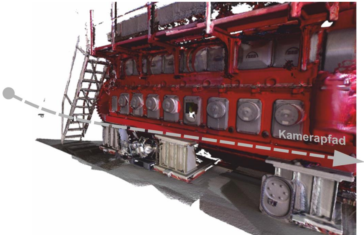
Abbildung 67: Funktionsprinzip des Aufnahmeverfahrens mit 3D-Kameras
