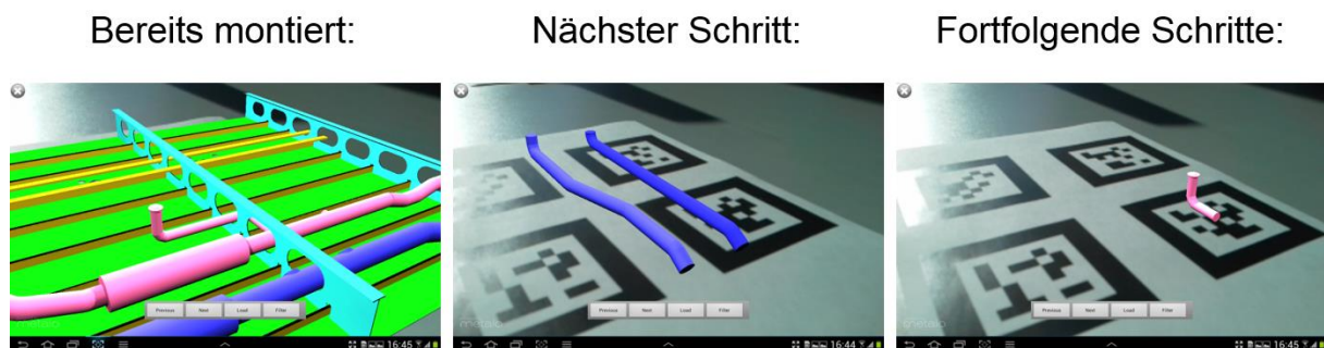
Abbildung 72: Filterung der 3D-Geometrie für die arbeitsschrittspezifische Anzeige
