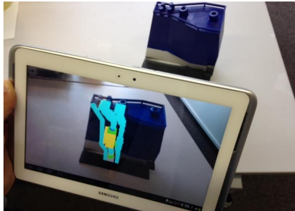
Abbildung 73: Einblendung von Geometrie in ein Miniaturmodell
