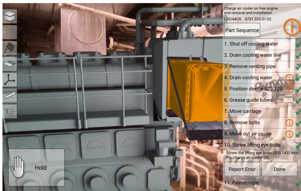
Abbildung 94: Prototypische Einblendung von Montageanweisungen
