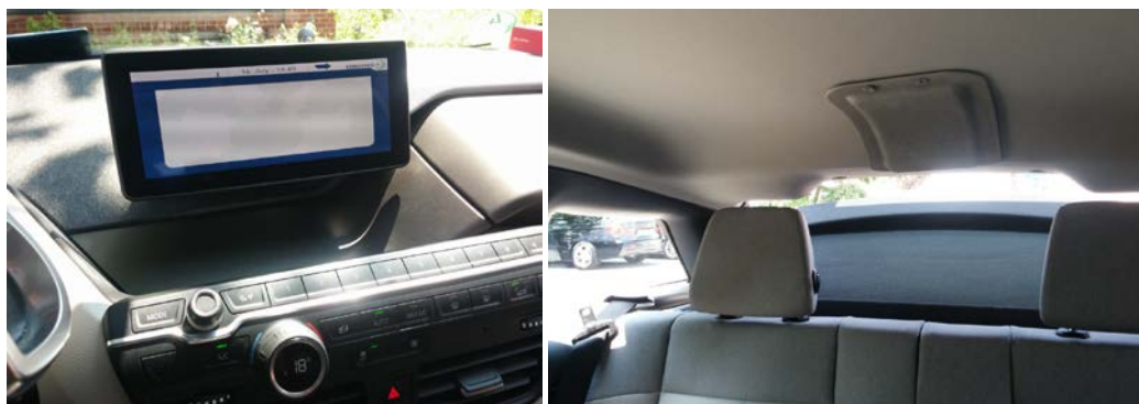
Abbildung 39: Converge HMI im CID und Verkleidung des Antennenausschnitts
