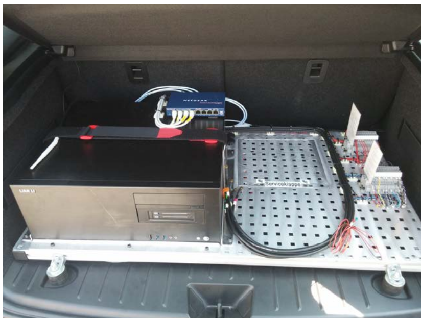
Abbildung 36: AU mit Linkbird im i3 in ein Gehäuse integriert (linker Teil)
