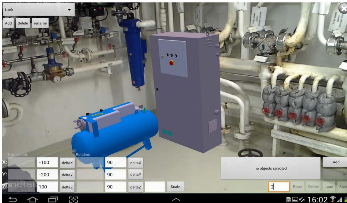
Abbildung 45 Aufstellungssimulation eines Drucklufttanks und Schaltschranks als AR-Anwendung
