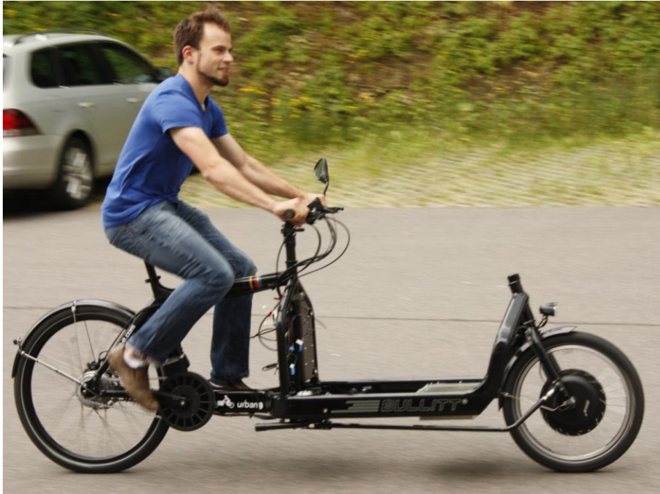
Bild 10: Testfahrt mit Doppelantriebssystem
