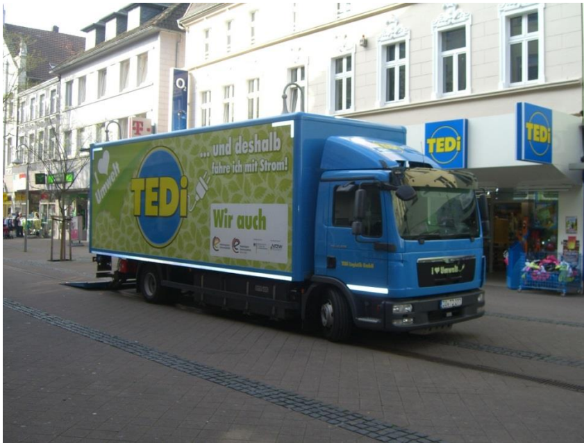
Abbildung 11: Von TEDI Logistik eingesetzter E-Fahrzeugtyp auf Basis des MAN TG 12.250, später als EMOSS CM 1216 vermarktet (© Fraunhofer IML 2015).
