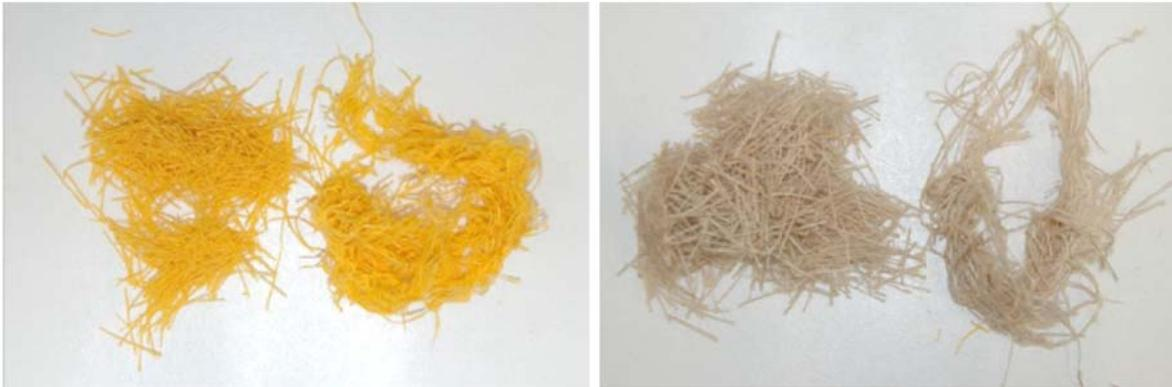
**Abbildung 13: Schnittgut eines Leinen- (links) und Hanfgarns (rechts) mit und ohne Stickstoffkühlung**
