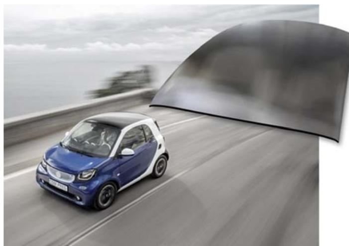
**Abbildung 40: Dachmodul in Sandwichbauweise, hergestellt im PUR-Sprühverfahren [36]**
