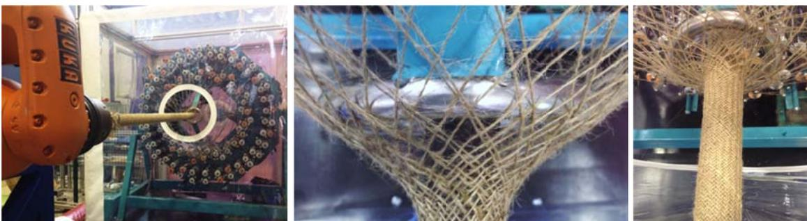
**Abbildung 25: Laborflechtrad mit 72 Spulenträgern sowie automatisierte Bewegung des Flechtkeims durch einen 5-Achs-Roboter (links); Aufspleißen der Naturfasern bedingt durch hohe Garnreibung (mittig) und Flechtstruktur mit  $\pm 45^\circ$  Faserorientierung und vermindertem Aufspleißen (rechts);**
