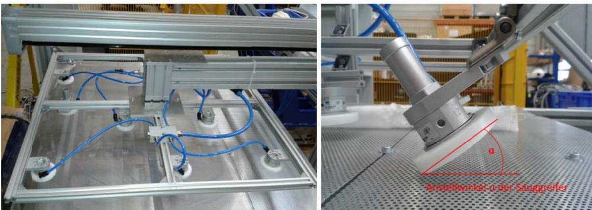
**Abbildung 24: Greifrahmen mit gleichmäßiger Anordnung der Sauggreifer der Fa. J. Schmalz GmbH (links); Anstellwinkel des Sauggreifers zur Aufnahme einzelner Textillagen (rechts)**
