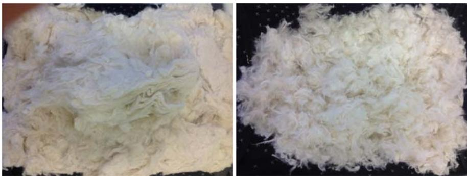
**Abbildung 7: Rohmaterial der Bambusfaser mit hohem Anteil von kompakten Faserbereichen (links) sowie aufgelöste und homogenisierte, flächige Preform (rechts)**
