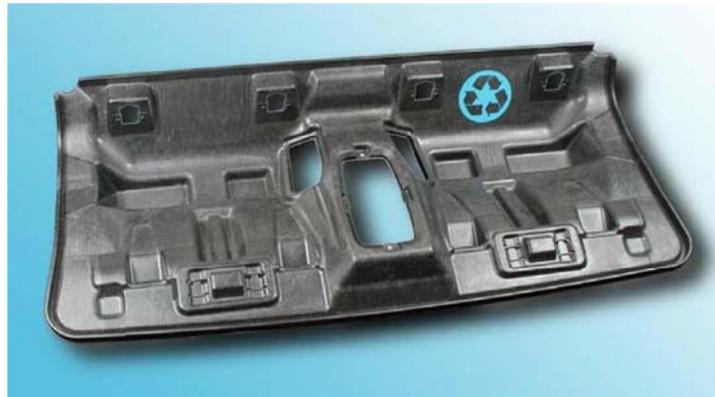
**Abbildung 39: Sitzschale des BMW i3 aus rezykliertem Carbonfaservlies, hergestellt im PUR-Sprühverfahren [35]**
