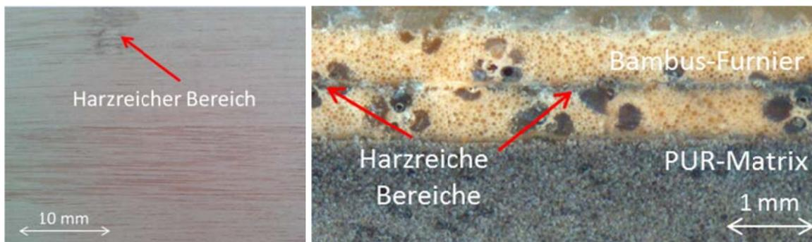
**Abbildung 22: Oberfläche eines Bambus-Furniers mit hoher Oberflächengüte (links) und guter Anbindung der Furnierlagen durch harzreiche Bereiche in den Zwischenlagen (rechts)**
