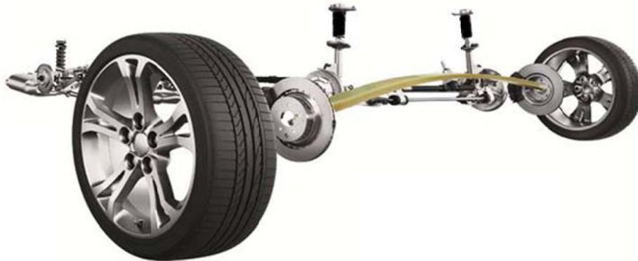
**Abbildung 41: GFK-Blattfeder mit Polyurethanmatrix, hergestellt im Hochdruck-RTM-Verfahren [37]**
