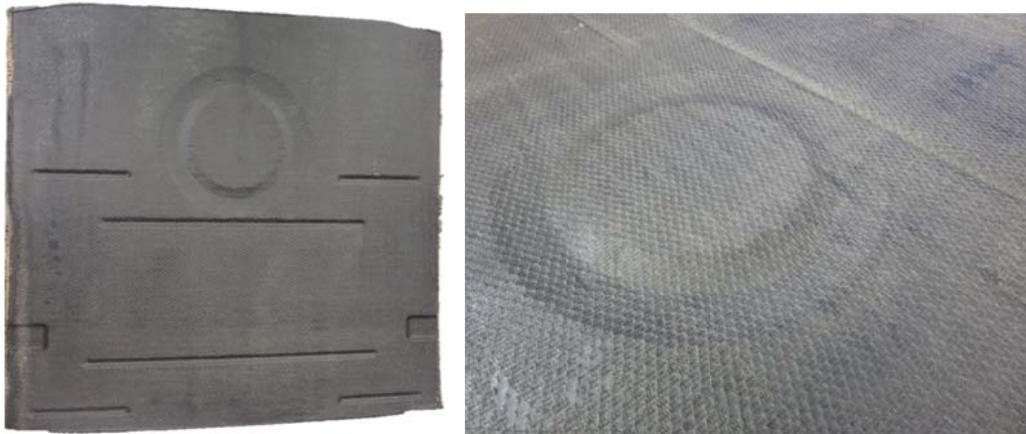
**Abbildung 36: Ladeboden mit Naturfaser-Decklagen und Papierwaben-Kern hergestellt im Polyurethan-Sprühverfahren**
