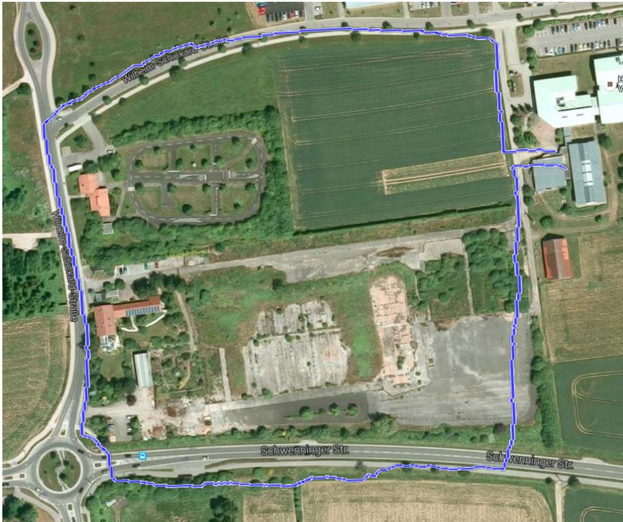
**Abb. 4:** Gemessene Trajektorie aus einer vollständig Energie-autarken Testmessung. Bei weiteren Messungen wurden je nach Testperson und Umgebungstemperatur Schwankungen der Lokalisierungsgenauigkeit um einige Meter pro 100 Meter Laufweg beobachtet. Die Reduzierung der Sensitivität gegenüber den genannten Einflüssen stellt jedoch kein grundsätzliches Problem dar und kann durch eine verbesserte Temperatur-Kalibrierung und algorithmische Anpassungen weiter minimiert werden.
