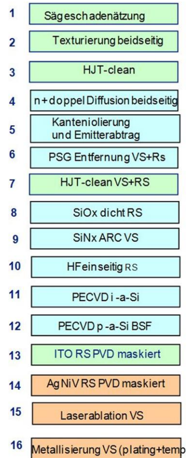
Abbildung 14: Prozessfluss zur Verknüpfung der Standard- mit der Heterojunction Zelltechnologie.
