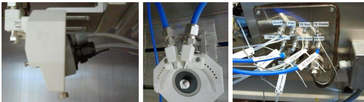
Abbildung 21: In Spraypyrolyse-Kammer eingebaute Breitstrahldüse.
