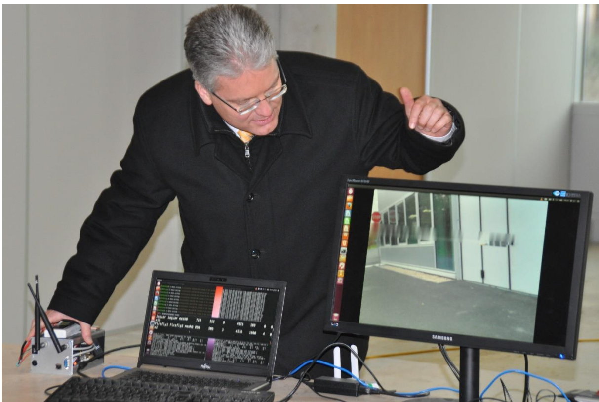
Abbildung 55: Videoübertragung in Real-Zeit über das WLAN Mesh beim Early Demonstrator (Quelle: TU Dortmund)
