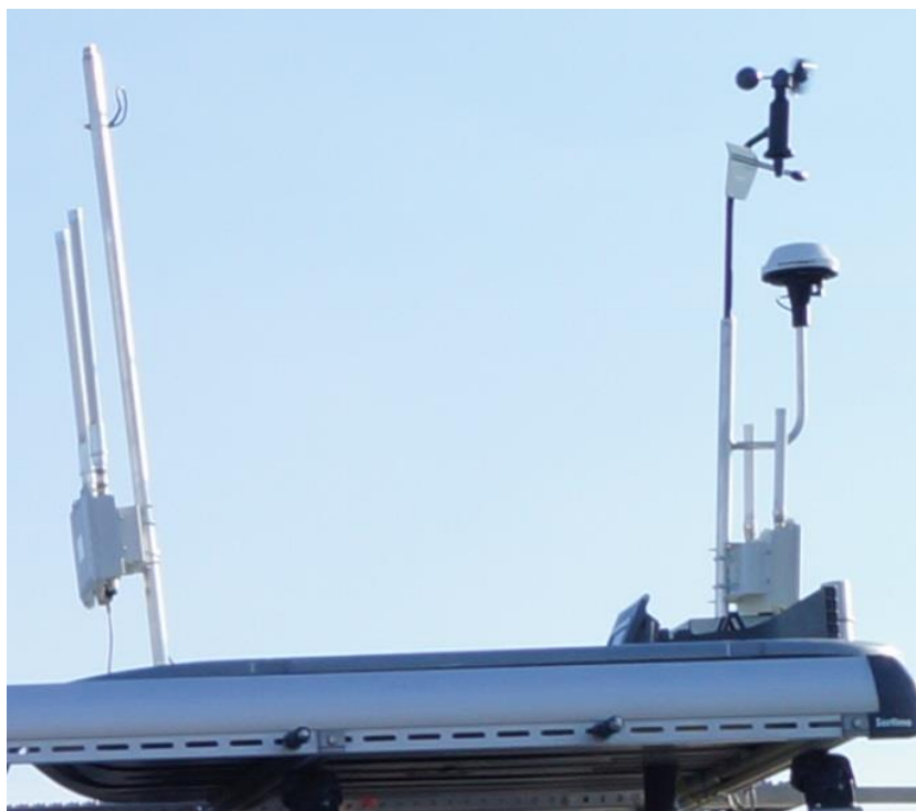
Abbildung II-5: Aufbau des Kommunikations- und Sensordecks.
