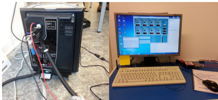
Abbildung 103: An einen Prüfkreis angeschlossen NaNiCl-Modul (links) und die grafische Oberfläche des Monitoring Software zur Erfassung der elektrischen Parameter (rechts).
