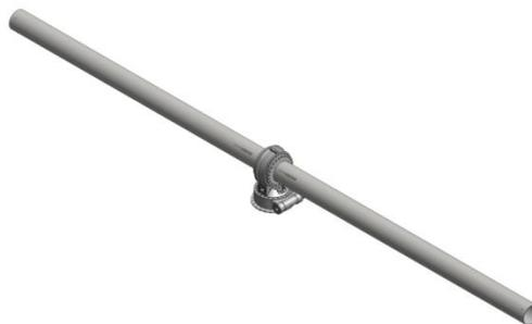
Fig. 14: Drehkopf Variante 3 mit Dual-axis drive
