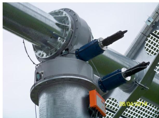
Fig. 35: Dual-Axis drive mit Motor-Getriebe Einheiten
