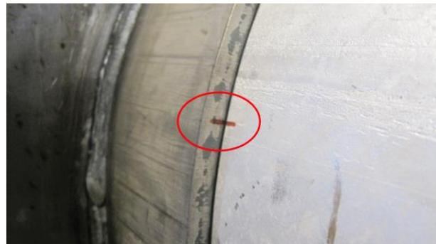
Fig. 45: Verdrehung Tragarm auf Tragrohr
