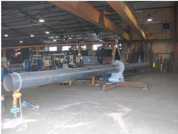
Fig. 47: Durchbiegung Tragrohre
