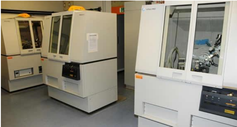
Abbildung 3: Drei PANalytical MPD Pro Röntgenpulverdiffraktometer zur mineralogischen Analyse von Gesteinen und speziellen Tonen [2]
