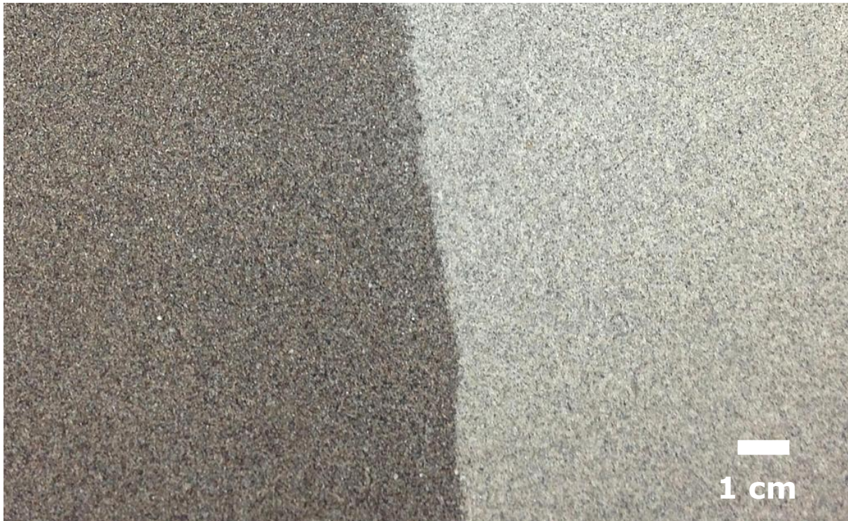
Abbildung 18: Vergleich der Fraktion 0,04 – 0,1 mm Mag (links, dunkel) und NonMag (rechts, hell) nach der Suspensionsmagnetscheidung des elektrodynamisch zerkleinerten Materials
