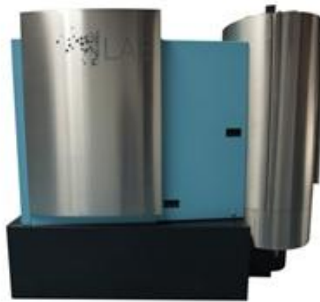
Abbildung 5: Elektrodynamische Labor-Zerkleinerungs Anlage (SELFRAG AG) [13]
