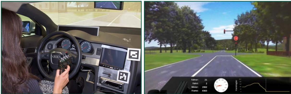
Abbildung 3. Versuchsaufbau der Fahrsimulatorstudie mit Handregler und synchronisierte Visualisierung der Handreglerwerte im aufgezeichneten Video der Fahrsimulation.
