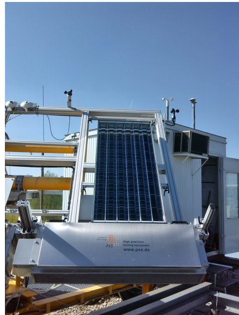
Abbildung 7.15: CPC-PVT-Versuchskollektor auf dem Solarteststand des ZAE Bayern aus zwei unterschiedlichen Betrachtungswinkeln.
