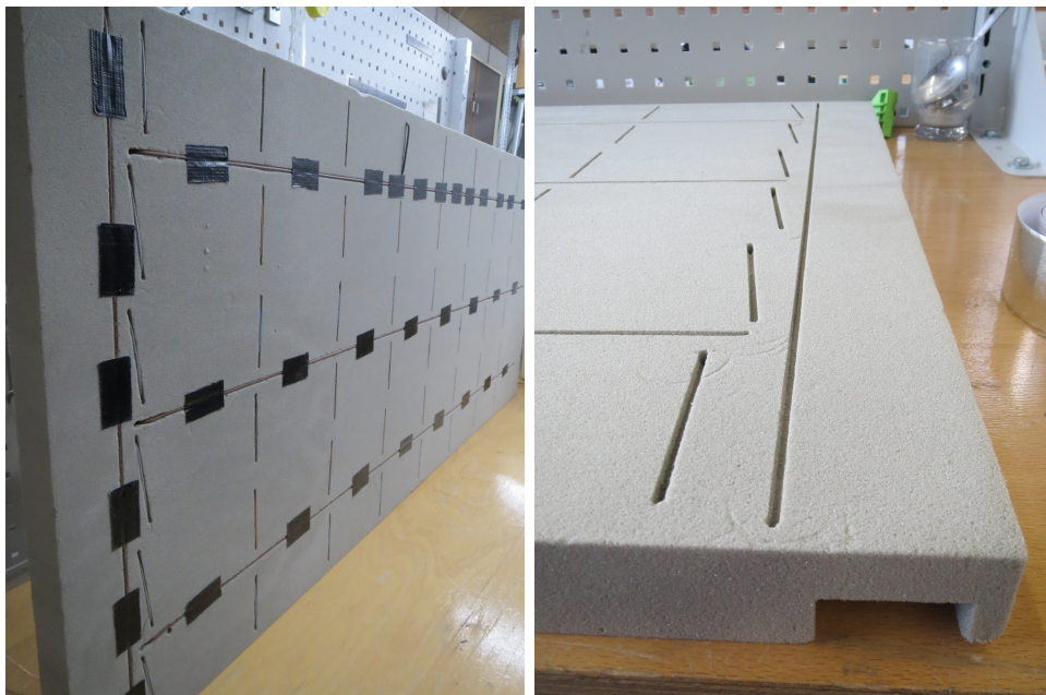
Abbildung 7.12: links : Rückseitige Unterbringung der elektrischen Sammelkontakte in der Isolierung. rechts : Die elektrischen Sammelkontakte werden durch Prägungen rückseitig plan eben untergebracht.
