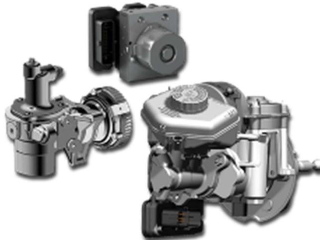
**Abbildung 26 Die drei Komponenten des Bremssystems in den e-generation e-Boxster Fahrzeugen, ESP®*plus* als Druckmodulationseinheit (oben), iBooster*hev* als elektromechanischer Bremskraftverstärker (rechts) und SmartActuator als zusätzlicher Volumenspeicher(links).**
