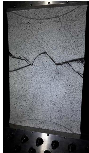
Abbildung 23: Vergleich der Bruchbilder: Der Patch versagt zuerst, der Restquerschnitt folgt
