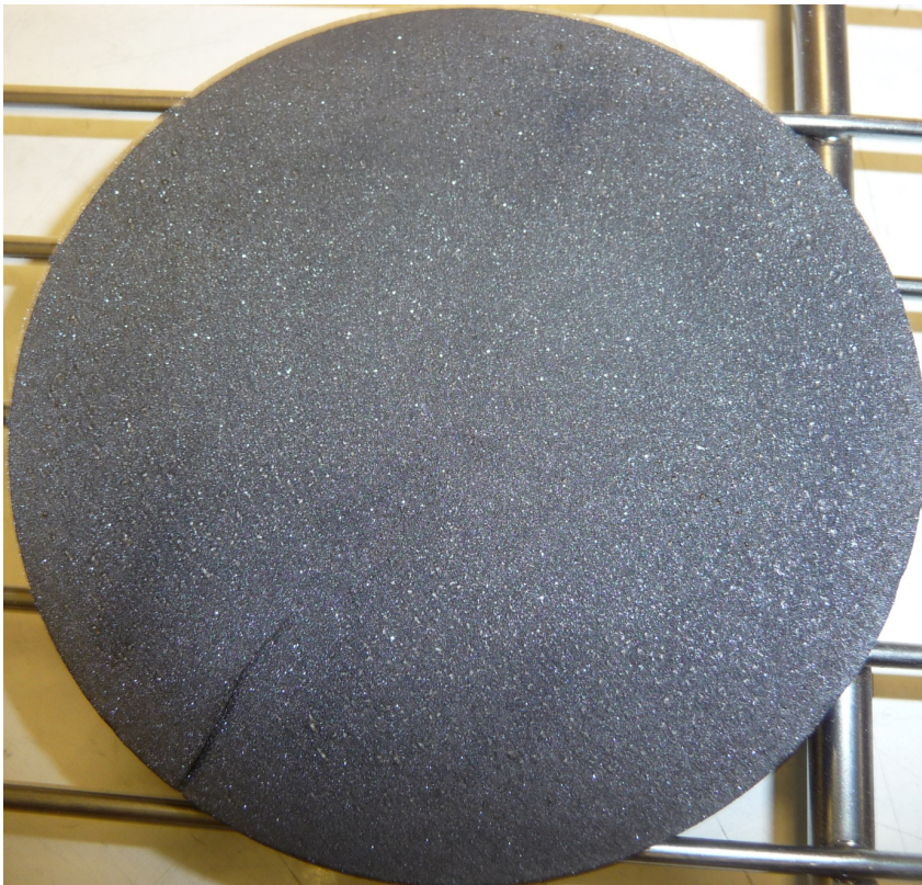
Bild 5: Target Scheibe Durchmesser 71 mm; Höhe 2,95 mm
