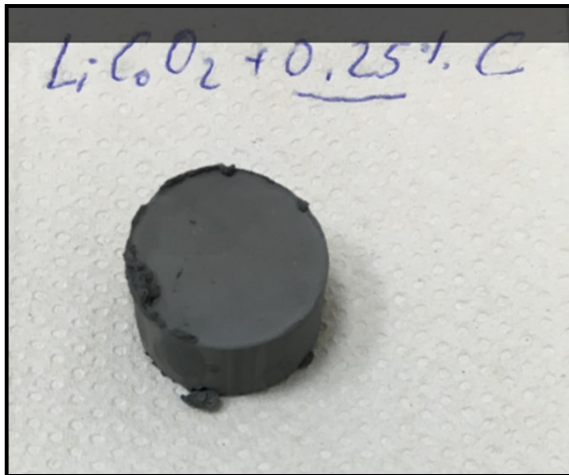
Bild 20: Obere Seite, rissfrei
