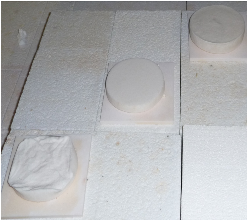
Bild 12: LiSO Serie 1: Antriebsversuch rissfrei Dichte ca. 92 %
