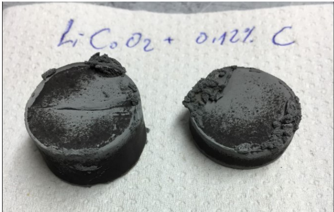
Bild 26: 2 Proben LiCoO 2 + 0,12% C. Dicke = 7mm und 15mm, gleicher Durchmesser von 18 mm
