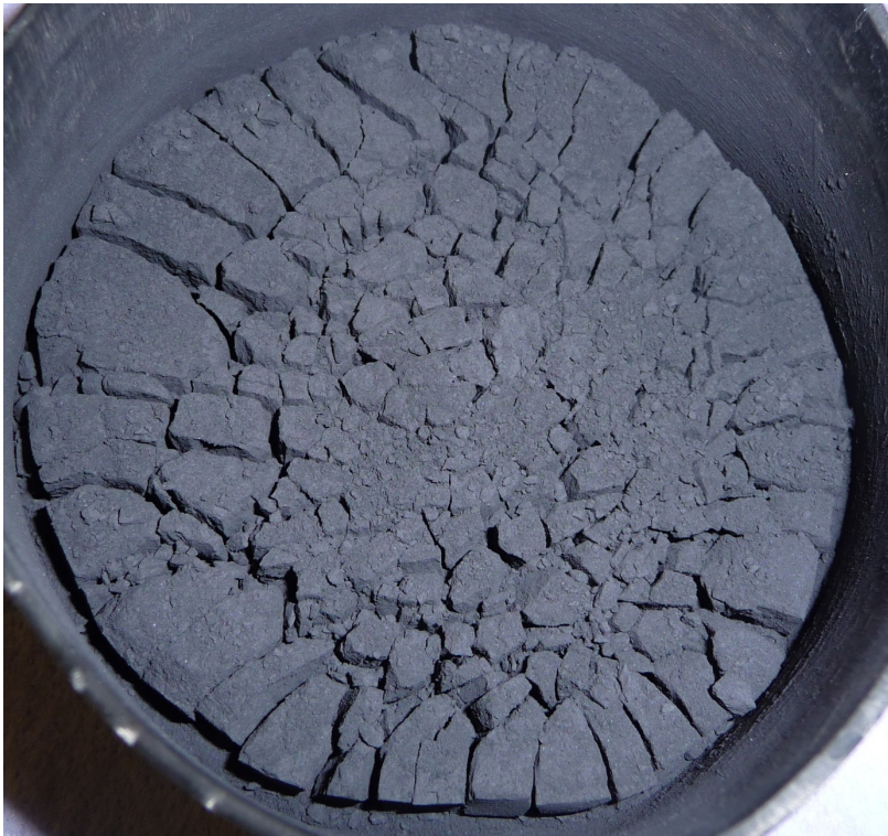
Bild 1: Typisches Rissbild; CI-gepresst binderfreies Rohmaterial
