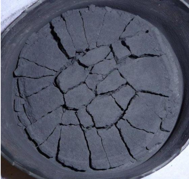
Bild 2: : Typisches Rissbild; CI-gepresst Rohmaterial mit Binderzusatz (üblich)
