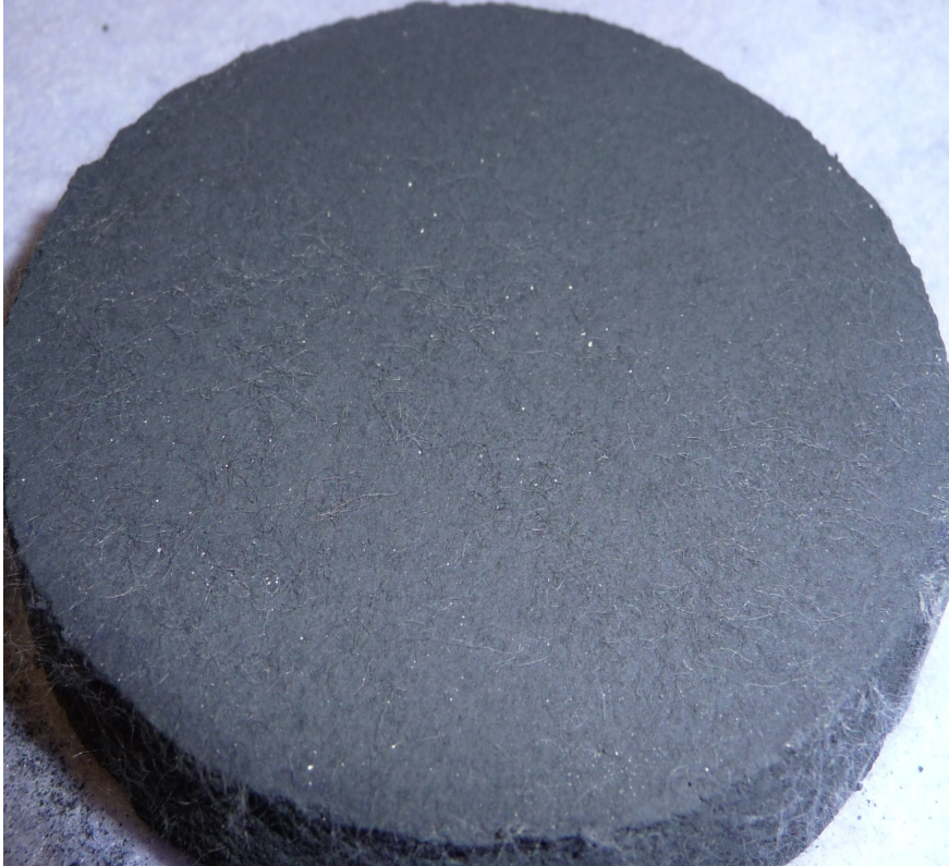
Bild 4: gecipte Probe, wie verwendet zur Herstellung der Testtargets
