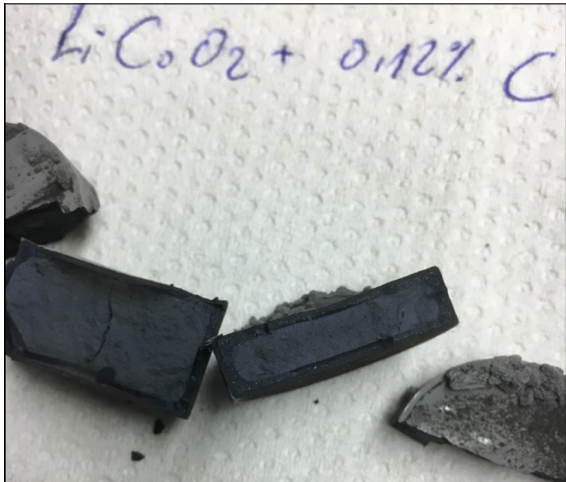
Bild 29: Bruchflächen der Proben mit 0,12% C
