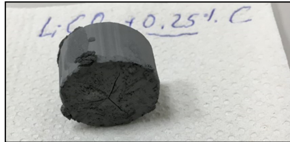
Bild 21: untere Seite, Risse zu sehen
