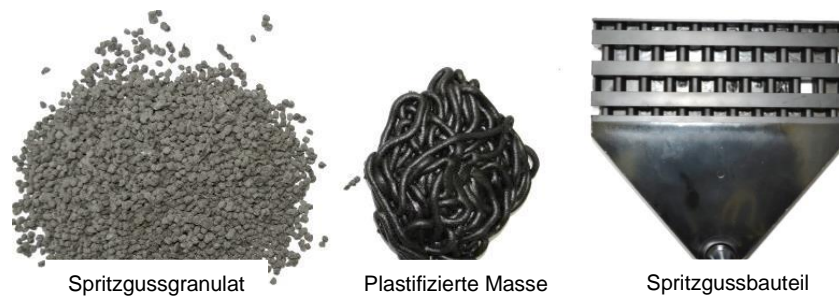
Abbildung 63: Werkstoffzustände einer duroplastischen Formmasse beim Spritzgießen
