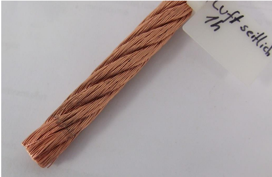
Abbildung 19: Ergebnis nach Entlackung
