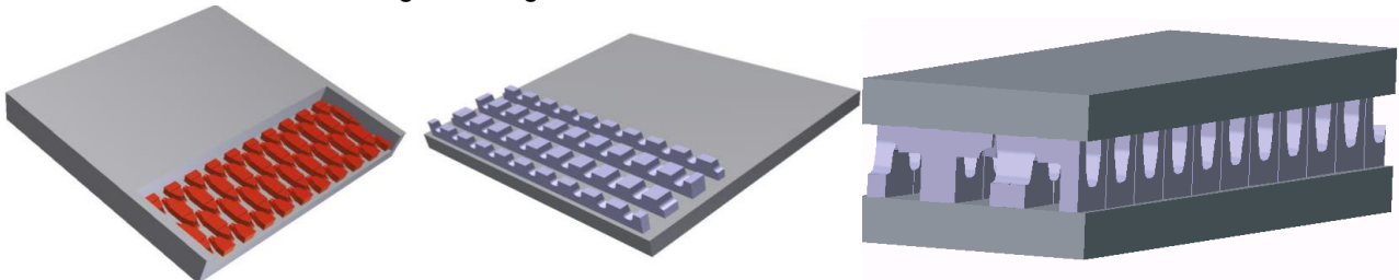
Abbildung 61: Konstruktive Werkzeugeinsätze mit Zahngeometrie für die Versuchsplatte
