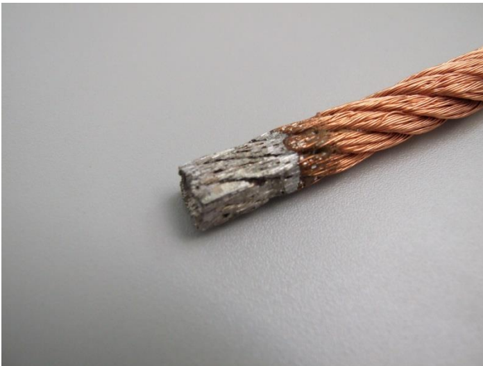
Abbildung 23: Kontaktierung mittels Tauchbadlöten
