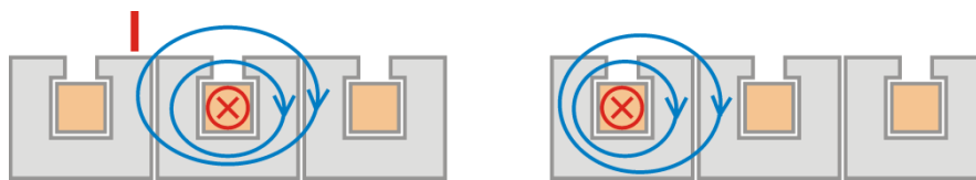
Abbildung 94: Statorfeste Anisotropie durch asymmetrische Streufelder in schematischer Darstellung
