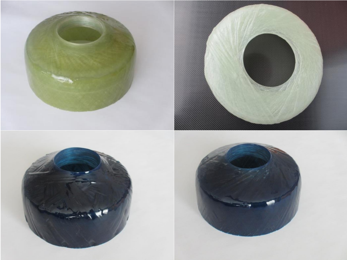
Abbildung 40 - Musterglocken, hergestellt mit unterschiedlichen Prozessparametern
