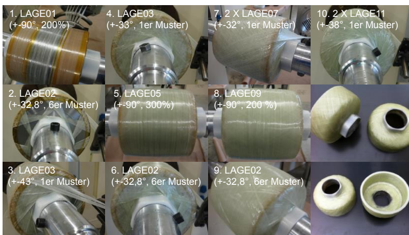
Abbildung 35: Nasswickeln der Rotorglocke
