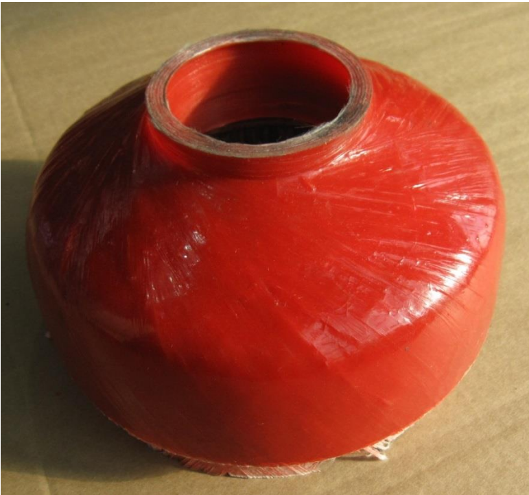
Abbildung 51 – Qualifizierungsmuster mit rot eingefärbtem Harz nach dem Entformen
