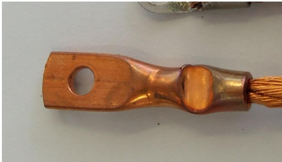
Abbildung 21: Kabelschuh nach erfolgtem Ultraschallschweißen
