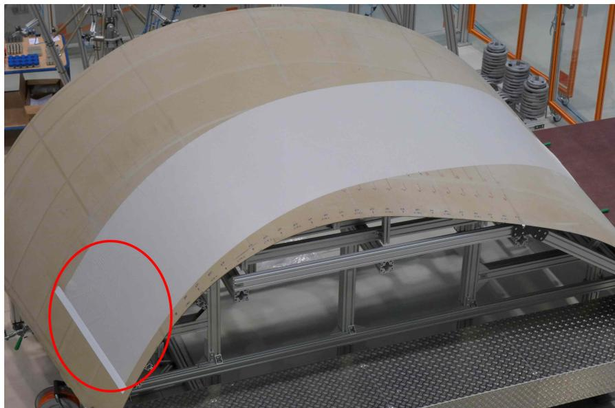
Abbildung 10: Ablageergebnis für neue Bahn ohne seitlichen Beschnitt. Markierter Bereich weist auf das Bahnanfangsproblem hin.
