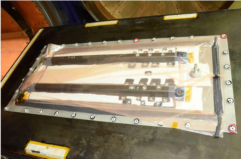
(a) Probeplatte mit Vakuumaufbau vor dem Prozess. Markiert wurden die zur Aufspannung des Koordinatensystems verwendete Marker.
