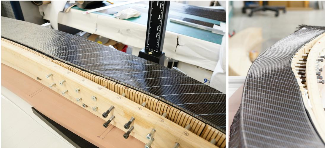
Abbildung 20: Vergleich der Ergebnisse einer Schwertumformung eines nicht-vorgespannten (links) und eines vorgespannten Traxialgeleges (rechts)
