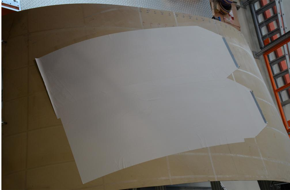
Abbildung 11: Ablageergebnis für zwei nebeneinander liegende Bahnen auf Male-Geometrie. Der Überlapp liegt zwar innerhalb der Fertigungsspezifikation, kann aber noch deutlich verkleinert werden. Durch die fast vollständige Automatisierung der Ablage des Bahnanfangs wurde auch das Anfangsproblem weitestgehend gelöst, nur der Tack der Anfangskante wurde mit einem Klebestreifen erhöht. Beide Bahnen weisen nur wenige unkritische Falten auf.
