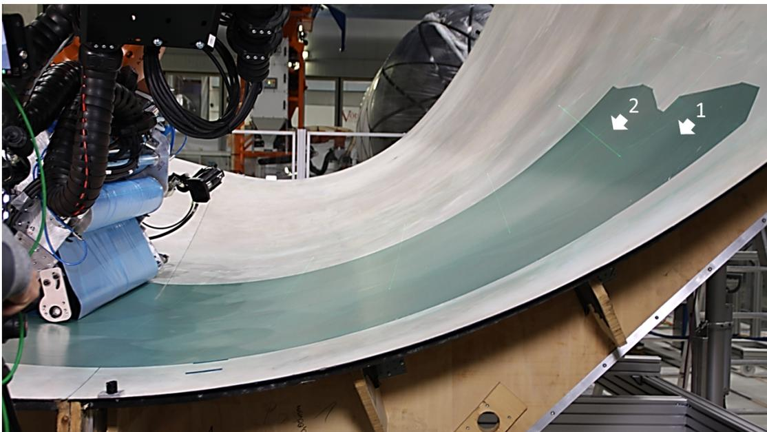
Abbildung 17: Großansicht der Ablagebahnen 1 und 2
