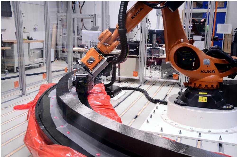
Abbildung 48: Vergleichsmessung zur mobilen Messeinrichtung mit baugleicher Kamera auf einem Roboter beim ZLP Augsburg.
