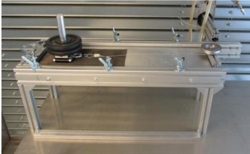
**Abbildung 15: Versuchsstand zur Ermittlung der Faserreibung (reale Ausführung)**
