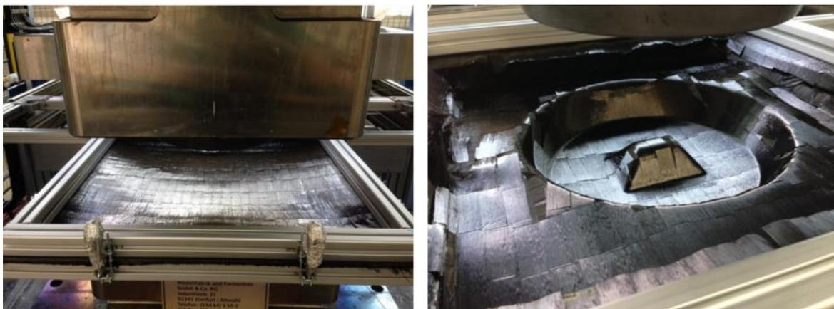
**Abbildung 13: Vorversuche zur Umformbarkeit des VLP-Textils**
