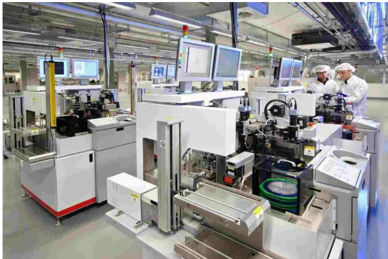
Abbildung 2 Linie 1 der Fertigung von Soitec zur Herstellung der Solarzellenbaugruppen („SCA“ – solar cell assembly)
