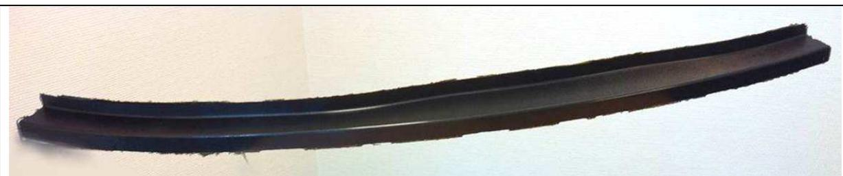
**Abbildung 2: Typical Frame NCF-Demonstrator (Quelle: CTC GmbH / xperion Aerospace GmbH)**
