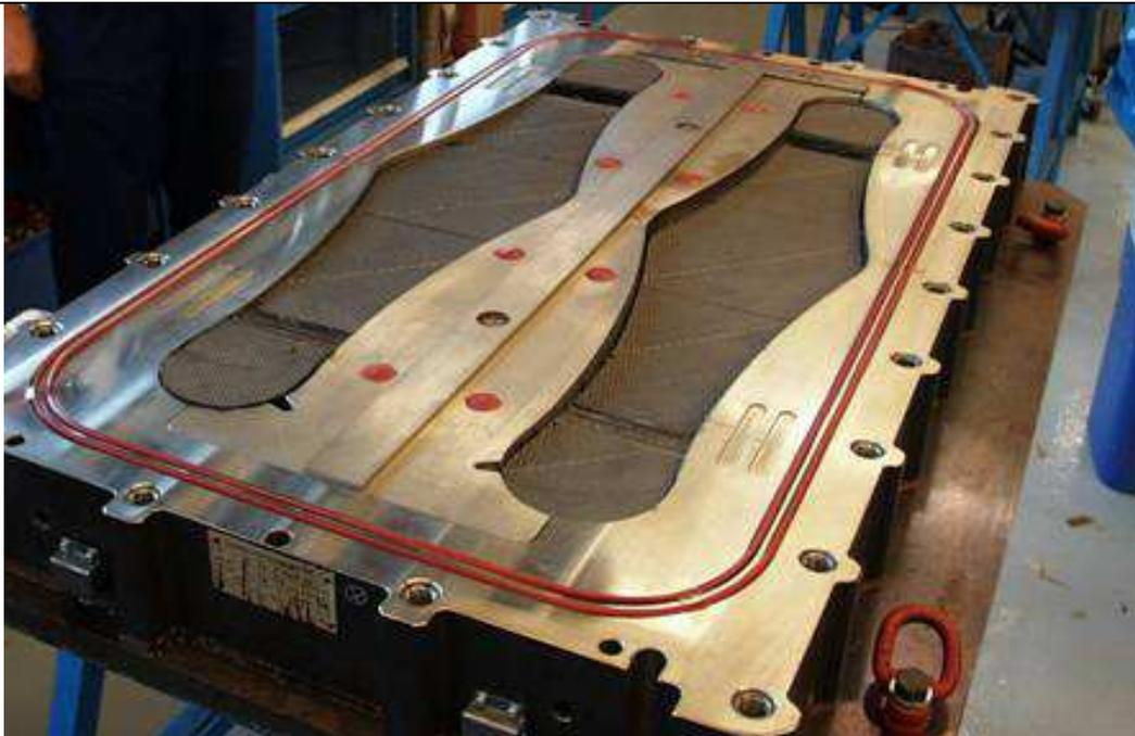
**Abbildung 40: Doppelfertigung von CFK-Höhenleitwerksschwingen in einer Aushärtevorrichtung im RTM-Verfahren [Quelle: Airbus]**
