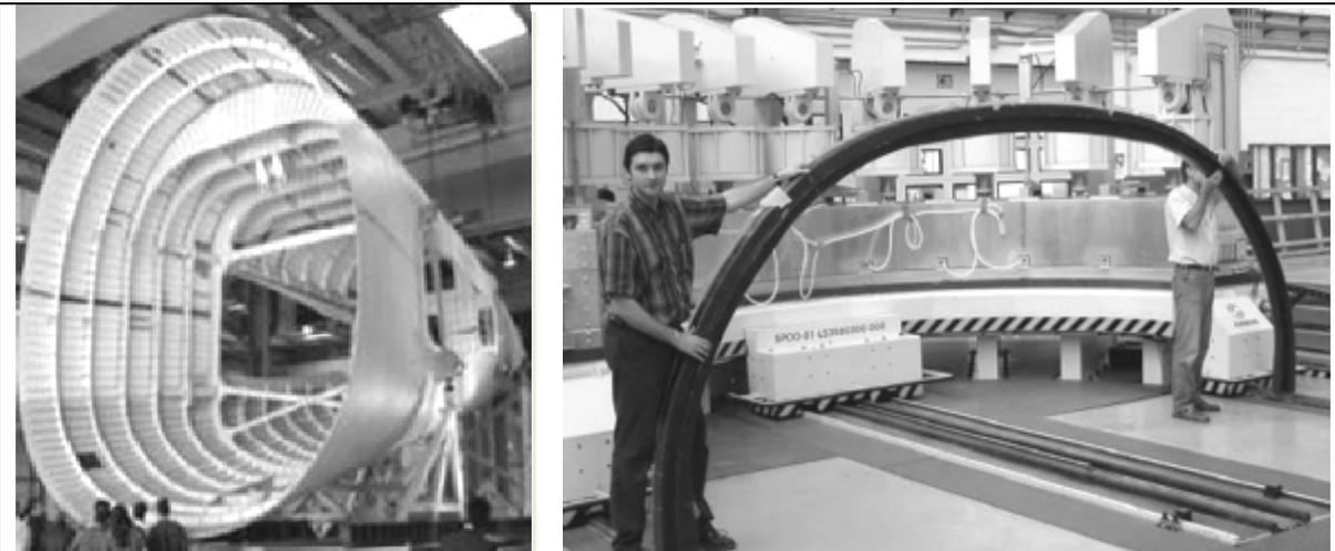
**Abbildung 1: Hecksektion des A380, teilw. mit CFK-Spanten (links), CFK-Unterschalenpanz mit sog. CL-Querschnitt für die Hecksektion ausgerüstet (rechts)**
