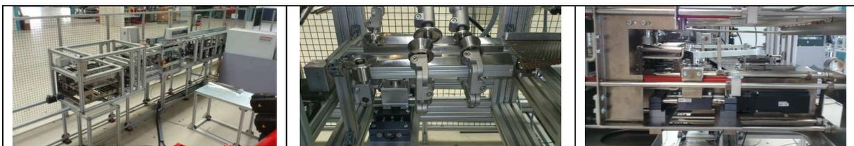
**Abbildung 17: Aktueller Status des kontinuierlichen Preformings: Modul für geraden Transport der Preforms (links), Querumformung (Mitte), Längsumformung (rechts) [Quelle: Brötje]**
