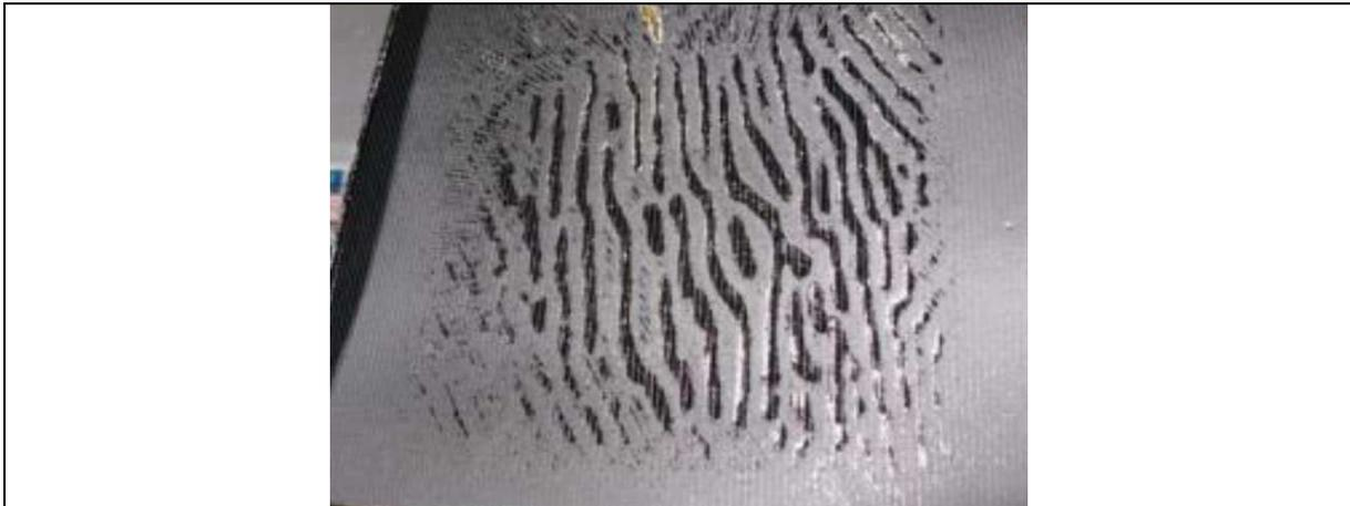
Abbildung 29: Faltenwurf bei den mit dem Harzfilm 977-2 hergestellten CFK-Versuchsplatten
