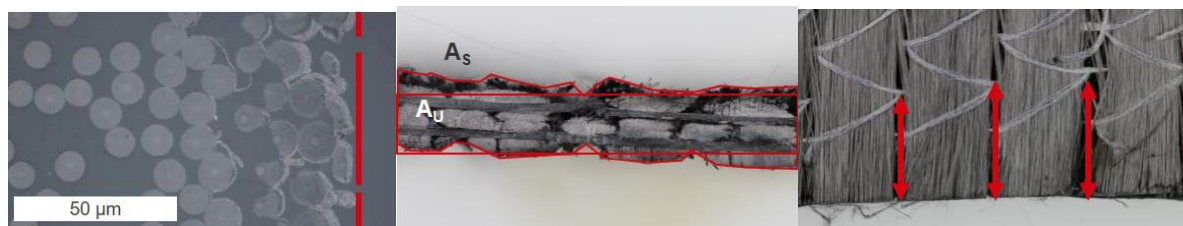
Abbildung 6: Untersuchte Phänomene beim Laserstrahlschneiden von CFK-Halbzeugen; Anhaften der Fasern (links), Aufstellen der Schnittkante (mitte) und Rückgang des Nähfadens (rechts)
