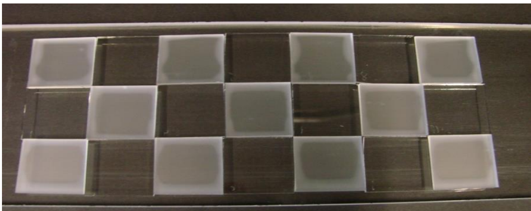
Abbildung 7: Begasungsversuch #2 bei 600 °C
