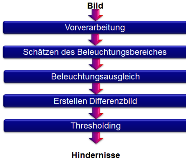
Abbildung 2.28: Grundlegender Ablauf der Schattenbasierten Hinderniserkennung.
