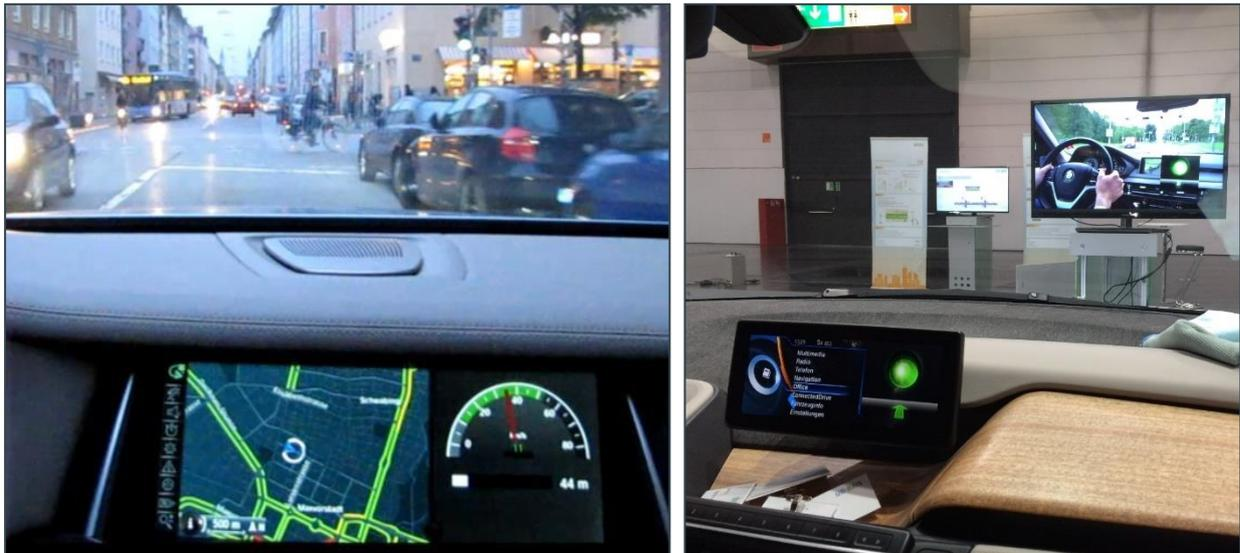
Abbildung 15: Umsetzungen der BMW HMI mit Grünband im Tacho (links) und Zustandsanzeige mit Pfeil (rechts)
