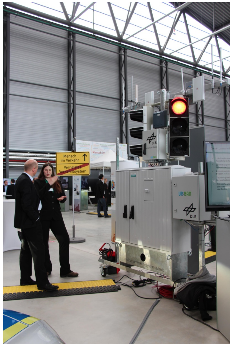
Abbildung 10: UR:BAN Halbezeitpräsentation: Car2X-Laboranlage versorgt Partnerfahrzeuge mit Car2X Nachrichten. Mit dieser LSA wurden auch Sende- und Empfangstests sowie Tests der Einsatzfahrzeug-Priorisierung durchgeführt.
