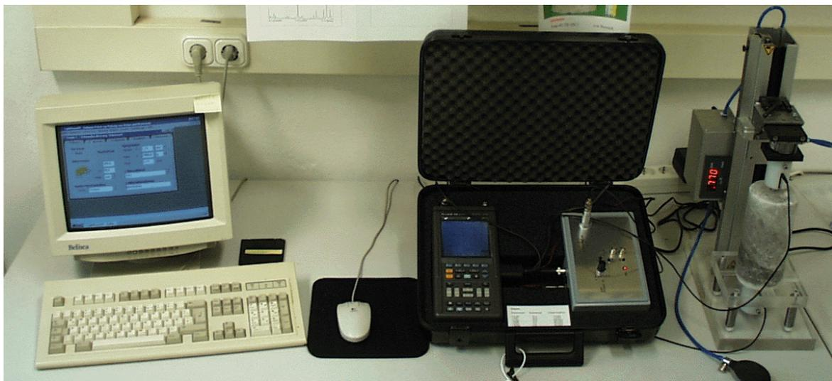
Abb. 3.1: Dehnwellenmessplatz des Lehrstuhls für Deponietechnik und Geomechanik
