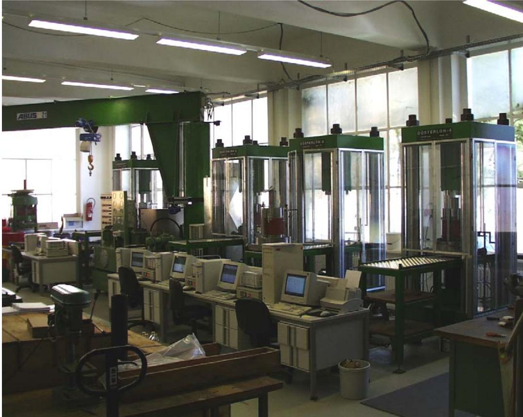
Abb. 4.1: 2500 kN-Druckprüfanlagen des Lehrstuhls für Deponietechnik und Geomechanik
