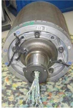
**Abbildung 46: Beispiel eines temperatursensierten Rotors, aufgebaut bei der Universität Kassel, Fachgebiet FSG**
