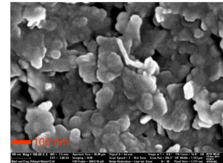
Abb. 22. REM-Aufnahmen der getrockneten Pulversuspensionen MgO (36 nm) nach der Ultraschallbearbeitung (USM) in Wasser im Vergleich mit der Vermahlung im Ethanol für 24 Stunden.
