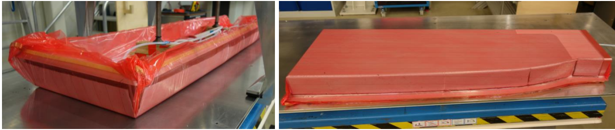
Abbildung 132: Innenwerkzeug mit Preform vor (links) bzw. nach (rechts) Anlegen des Vakuums
