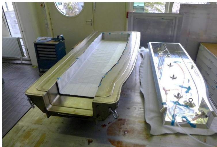
Abbildung 126: Aushärtewerkzeug mit Preform und vorbereitetes Innenwerkzeug
