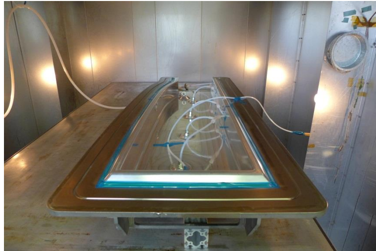
Abbildung 127: VAP-AP Aufbau während der Infiltration
