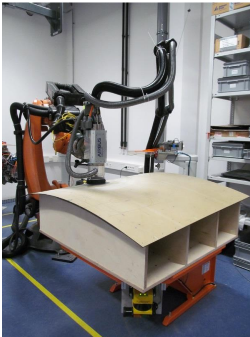
Abbildung 22: Durchführung der Fräsungen auf dem A350 Schalensegment
