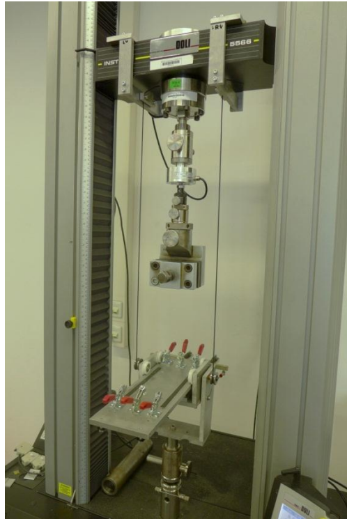
Abbildung 105: Prüfvorrichtung für Abreiß-Versuche
