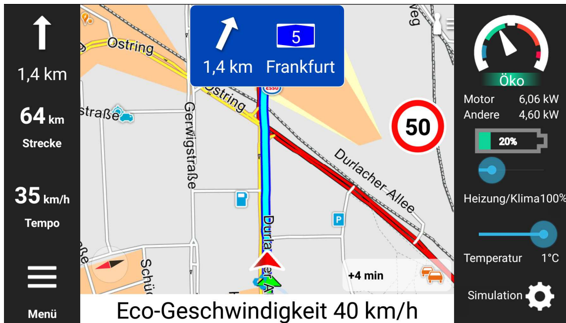
Abbildung 11: Beispiel Fahrhinweis zum energiesparenden Fahren
