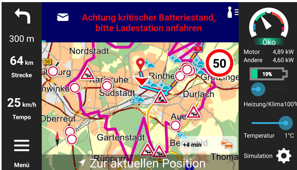
Abbildung 10: Darstellung Fahrhinweise, Beispiel: Warnhinweis Batteriestand
