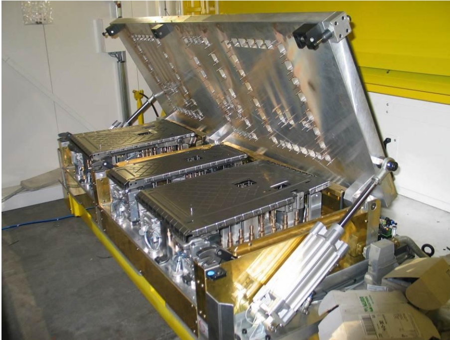
Abbildung 6: Rücksitzlehne Stahl in Serienwerkzeug B&S
