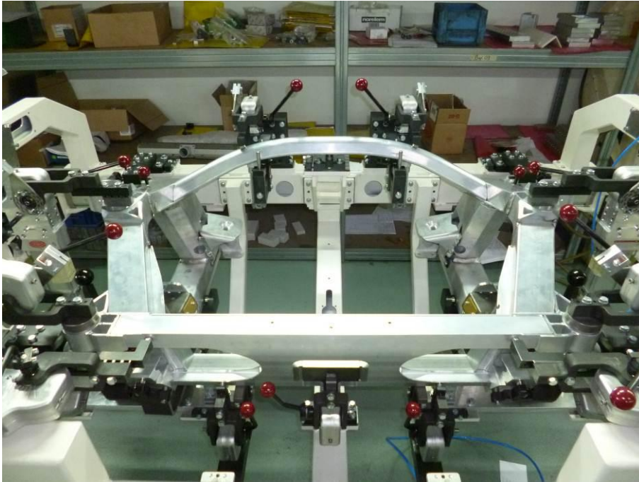
Abbildung 4: Integralträger Aluminium in Prototypenvorrichtung B&S
