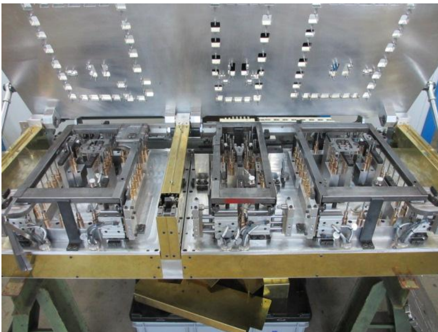
Abbildung 7: Vorzusammenbau Rücksitzlehne in Serienwerkzeug B&S
