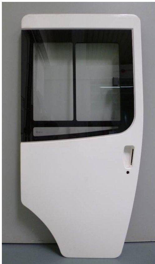
Abbildung 15: CFK-Wohnmobiltür weiß lackiert mit eingeklebtem Fenstereinsatz Vorrichtungsbeschreibung:
