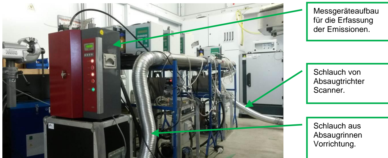
Abbildung 22: Messgeräteaufbau in Anlage Laser Zentrum Nord
