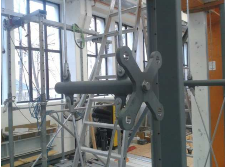
Druck- und Zugstab mit montiertem Spider
