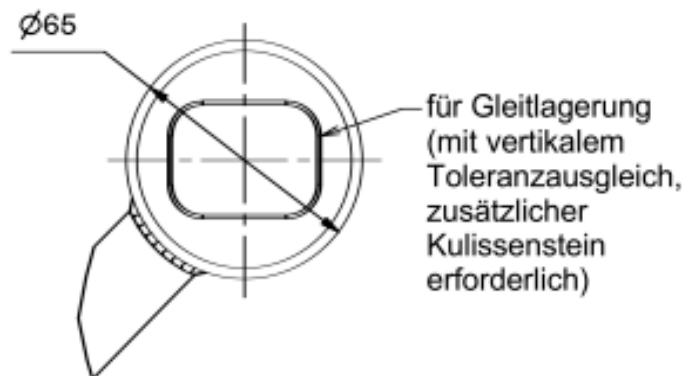
Gleitlager mit Toleranzausgleich
