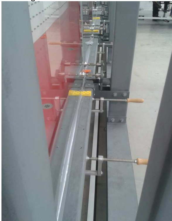
Wölbung nach innen ist deutlich zu erkennen
