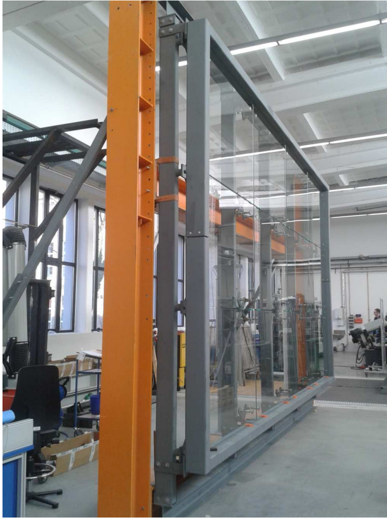
Starre Fassade im Prüfstand
