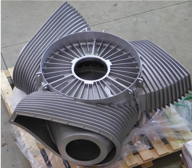
Abbildung 99: Nabenmodell mit angegossenen Kühlrippen
